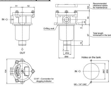
Les filtres de la série MPF sont utilisés sur les circuits retour et sont montés semi-immergés en sommet de réservoir.
